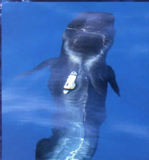
La marca queda adherida al lomo del calderón mediante dos ventosas. El tiempo de permanencia sobre el calderón es programado por el Dr. Mark Johnson. (Foto: P. Aspás).
